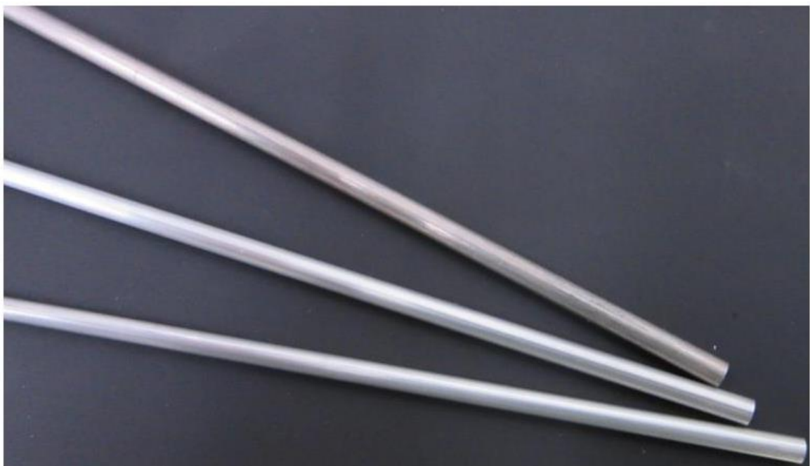
開発した押し出し技術により作製した長尺マグネシウム合金細管の外観写真
